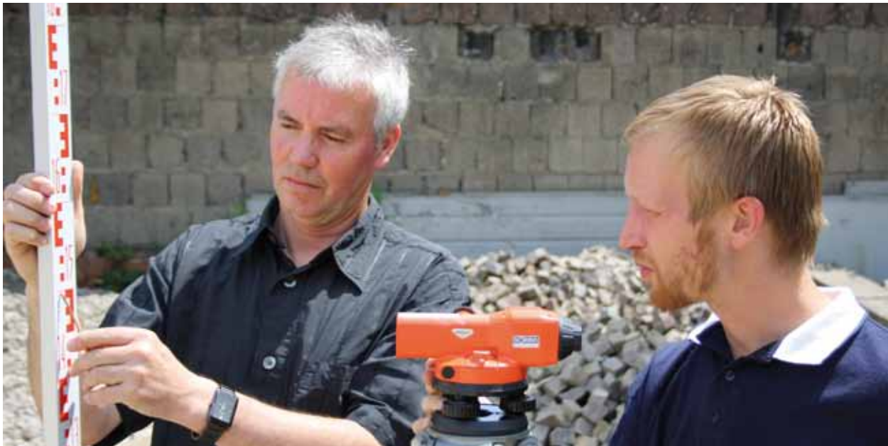
Nachqualifizierung zum Landschaftsgärtner, Modul Vermessung: Ein Ausbilder (links) übt mit einem Teilnehmer der Nachqualifizierung die Vermessung mit einem Nivelliergerät.
